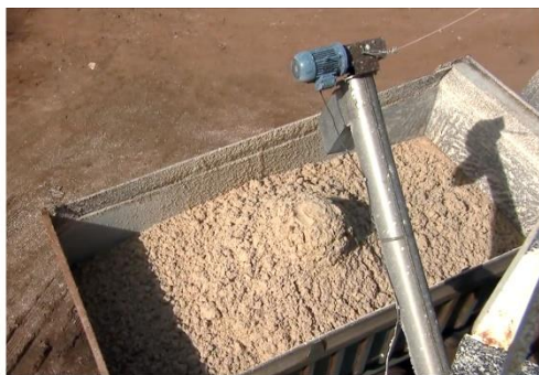
Figura 3 – Massa ou bagaço. Resíduo sólido gerado no processo de fabricação de fécula de mandioca. Apresenta aspecto pastoso e colocação clara. Fonte: PRIA, 2015.
